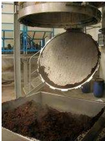
Pepita tratada. Vaciado del extractor.
